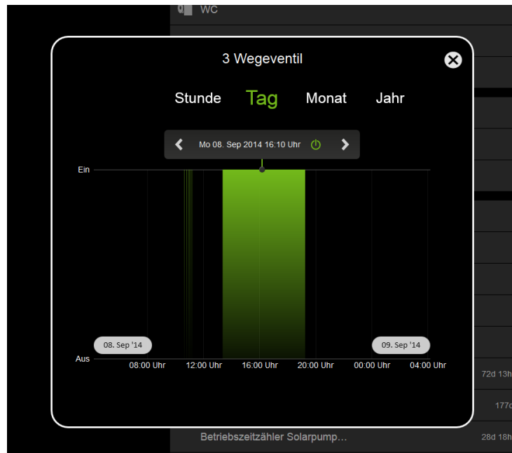
Screenshot 7: Zustand des 3-Wege Ventils
